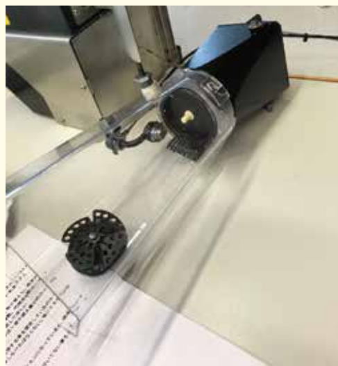
分解可能な攪拌ミキサー。モーターから容器が取り外せ、分解して清掃が可能となる。2020年以降に供給開始予定。
