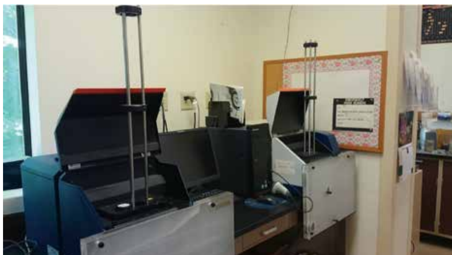
NIR 分析機器と分析サンプル。乾燥させたサンプルを粉碎し、セルと呼ばれる丸い容器に入れて分析する。
