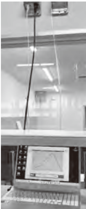
▲ 搾乳ユニット内の給餌ボックスの裏側には吸気チューブが設置してあり(写真左、中)、パソコンとセットになった測定器に接続されていて(写真右)、牛が搾乳ユニット内で飼料を食べている時の呼気中のメタン濃度と二酸化炭素濃度を測定して、その比率から推定式を使って計算するシステムになっています
